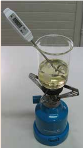
Εικόνα 21. Ανάδευση του μίγματος πάνω στη θερμαντική εστία και μέτρηση της θερμοκρασίας του.
