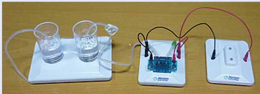
Εικόνα 29. Πειραματική διάταξη «Παραγωγή ηλεκτρισμού με χρήση κυψέλης υδρογόνου»
