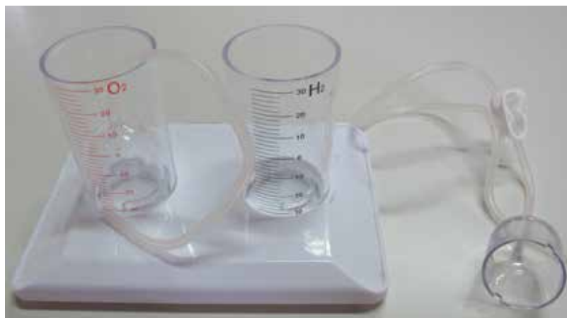
Εικόνα 26. Το σύστημα αποθήκευσης των αερίων της ηλεκτρόλυσης
