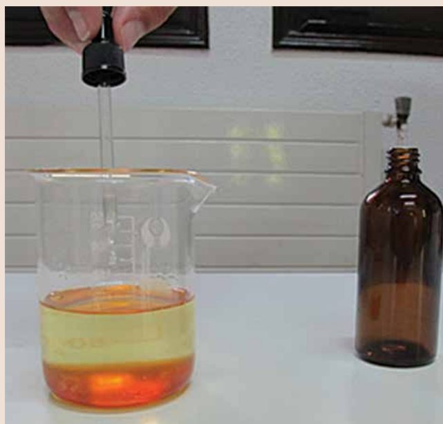
Εικόνα 22. Διαχωρισμός φάσεων - Παραγωγή βιοκαυσίμου
