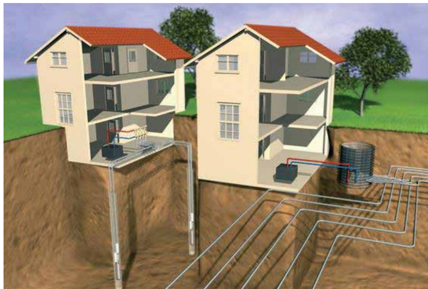
Εικόνα 14. Θερμικές εφαρμογές γεωθερμίας
